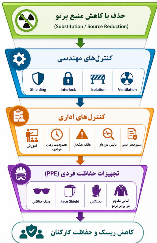
شکل ۱. سلسله‌مراتب کنترل مواجهه با پرتوهای غیریونساز بر اساس اصول مدیریت ریسک و استانداردهای ایمنی پرتو (۸-۱۱).
