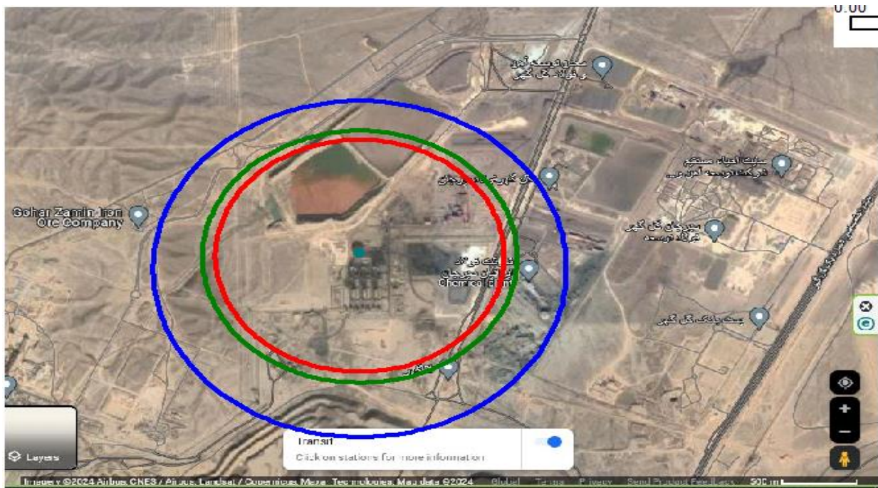
نقشه ۱. شعاع فشار ناشی از انفجار از منبع رهایش بر روی نقشه
