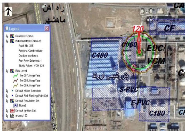
شکل ۳. کانتورهای ریسک فردی مخزن وینیل کلراید
