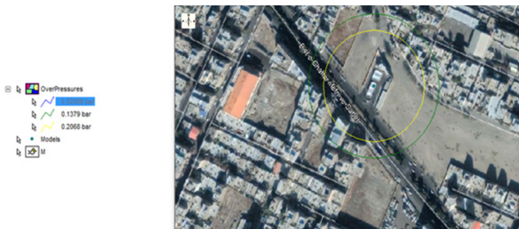
شکل ۳. میزان افزایش فشار در اثر انفجار در اطراف مخزن گاز متان در مدل جرم معادل TNT
