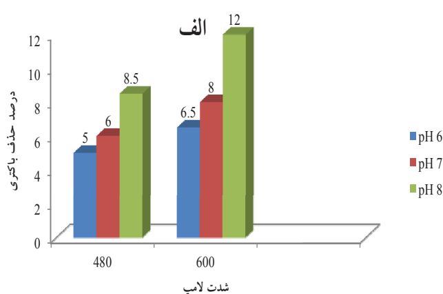
نمودار ۳ - درصد حذف باکتری پseudomonas آئروژینوزا در فوتورآکتور الف) 10^3 عدد در میلی لیتر، ب) 10^2 عدد در میلی لیتر در زمان تابش 45 دقیقه، فاصله لامپ تا سطح نمونه 1/5 سانتی متر و شدت‌های مختلف لامپ
