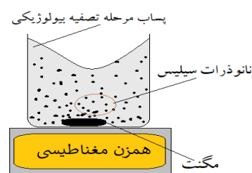
شکل ۲- اختلاط پساب فرایند بیولوژیکی با نانوذرات سیلیس
