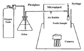
**Figure 1. Fluid filtration apparatus**
